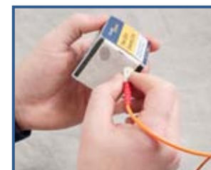
Figura 31 – Metodología de limpieza “de húmedo a seco”. Aplicar una cantidad mínima de disolvente en el borde de una toallita. Manteniendo el extremo del conector perpendicularmente, frote el extremo desde el punto húmedo a la zona seca
