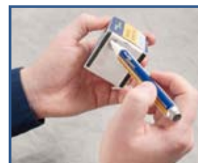
Figura 31 – Metodología de limpieza “de húmedo a seco”. Aplicar una cantidad mínima de disolvente en el borde de una toallita. Manteniendo el extremo del conector perpendicularmente, frote el extremo desde el punto húmedo a la zona seca
